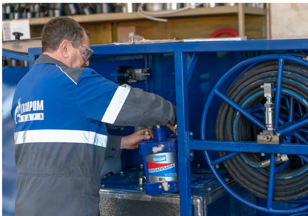
Юрий Сазонов, слесарь механосборочных работ 6-го разряда, ведет сборку установки нагнетания смазки УНС-100
