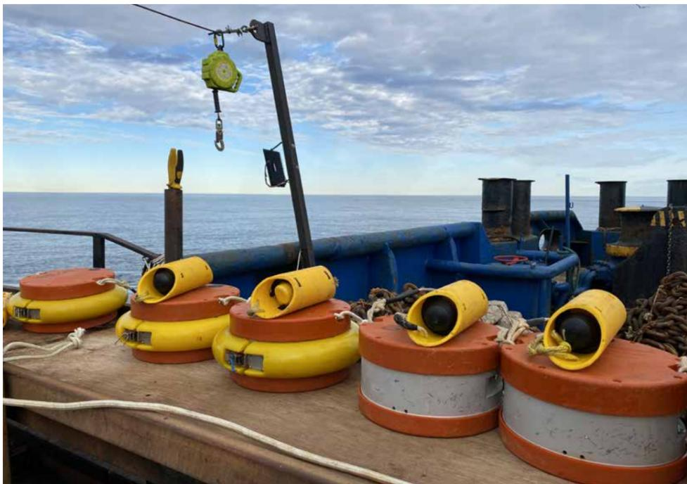
Каждая станция «Краб» представляет собой автономный водонепроницаемый блок
