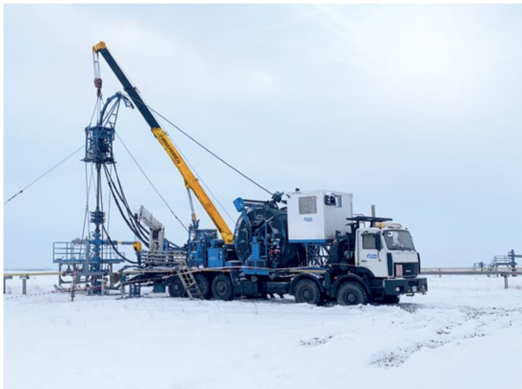
Проведение ГИС при контроле за разработкой на Уренгойском НГКМ с помощью флота ГНКТ
