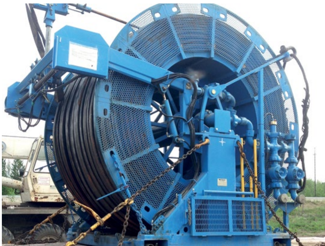
Узел намотки безмуфтовой длинномерной трубы для колтюбинговой установки
